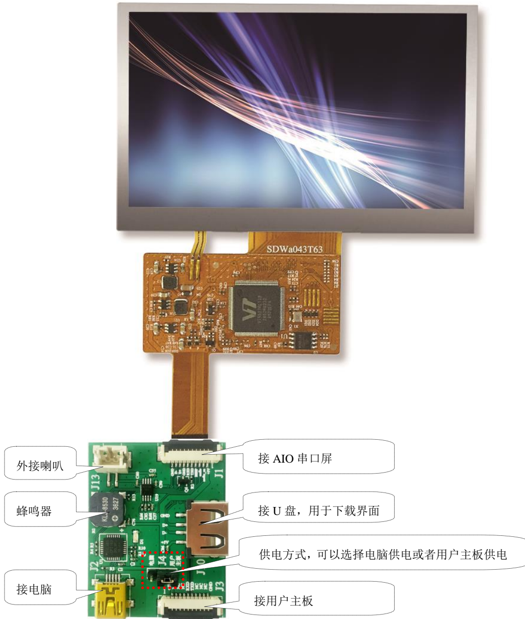
图 5 转接板 AIO01 与 SDWa 系列 AIO 串口屏的连接
